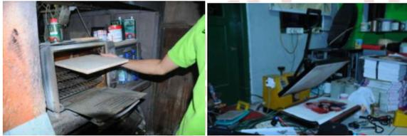
Gambar 5 Proses pengeringan menggunakan jenis oven listrik dengan suhu 200 derajat (kiri) dan Mesin pemanas yang digunakan untuk mentransfer gambar ke dalam media cetak dengan menggunakan suhu 200 derajat (kanan).
