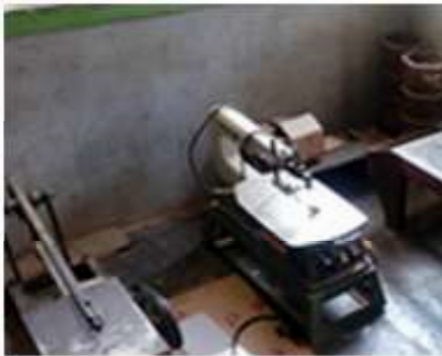
Gambar 20. ScollSaw untuk memotong bahan kerajinan kayu (Dok. Penulis)
