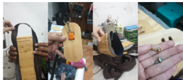
Gambar 10. Prototype dari kayu dijahit dengan kulit (Sumber: Raharja, 2019)
