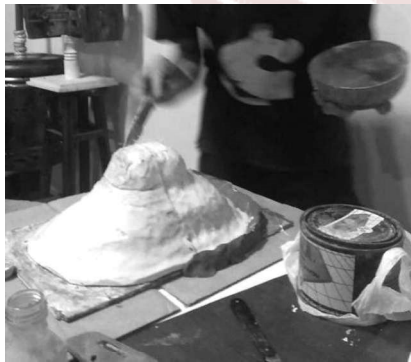
Gambar 3. Pencetakan dengan silicone rubber sebagai anak cetakan dan resin sebagai induk cetakan pada model tanah liat
