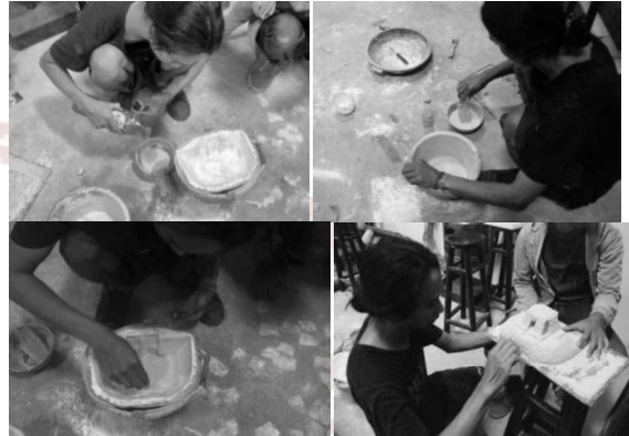
Gambar 4. Proses pecetakan cinderamata dengan bahan resin
